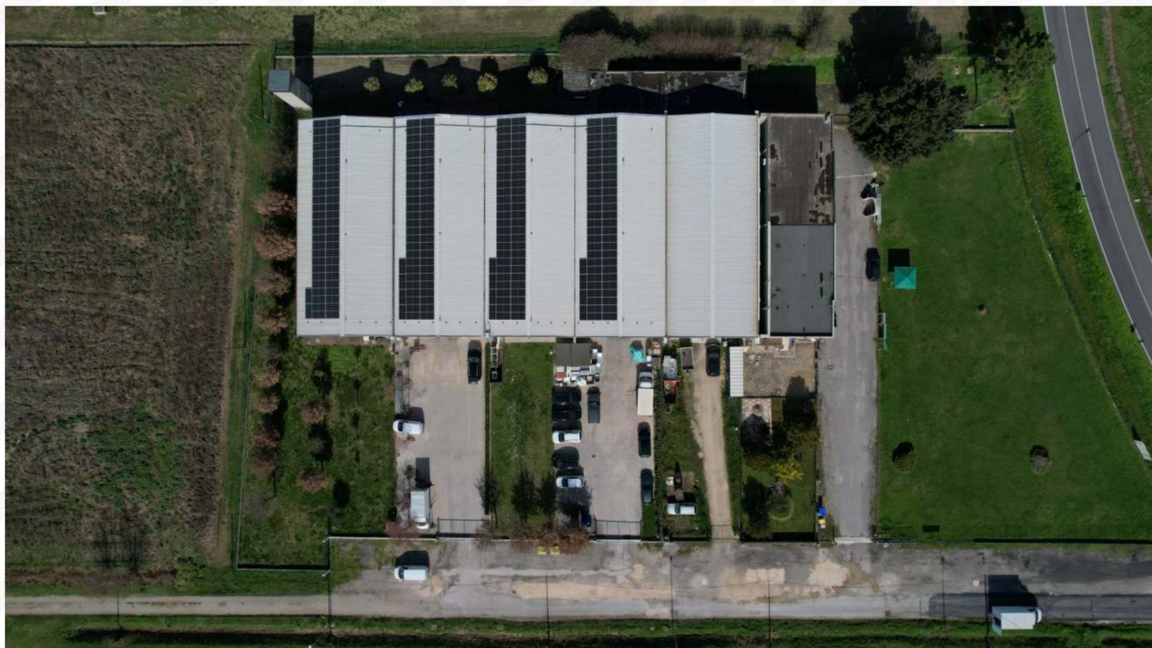
Il progetto prevede l'installazione sui tetti del sito produttivo di n. 222 moduli fotovoltaici della potenza di 450 Wp cadauno per una potenza complessiva di 99,9 kW, abbinati a n. 3 batterie di accumulo per complessivi 49,2 kWh con l'obiettivo di ridurre del 40 % circa il fabbisogno annuale di energia elettrica.
